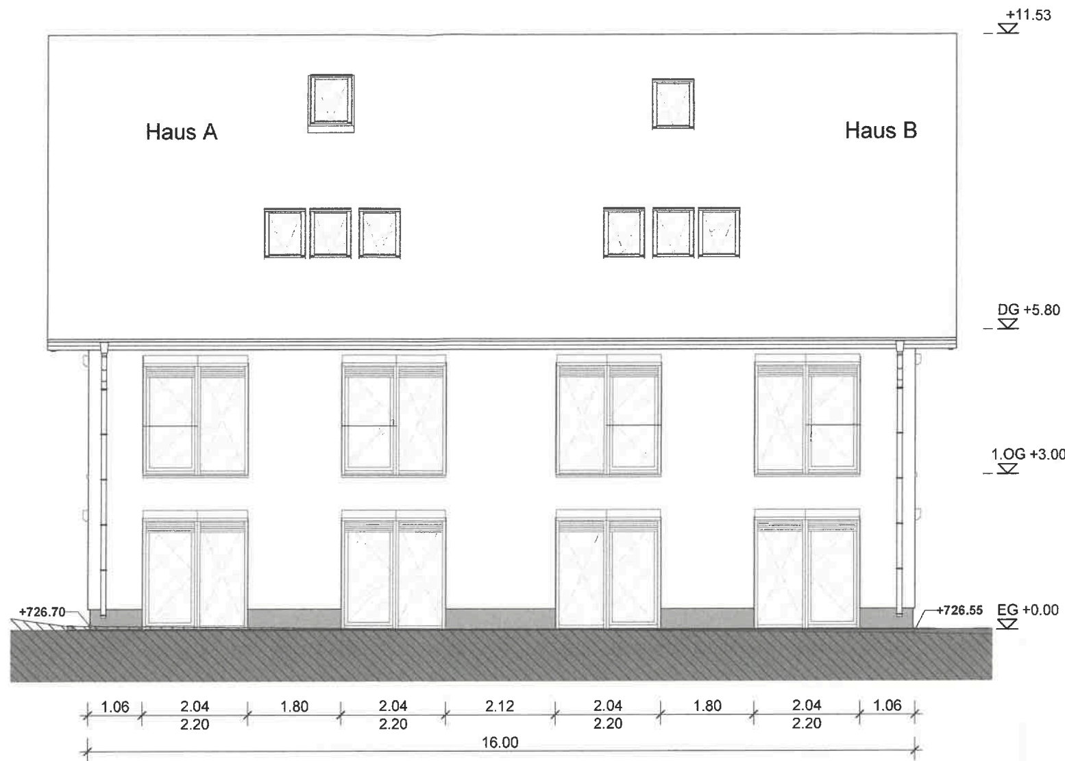
Ansicht von Süden Haus A-B
